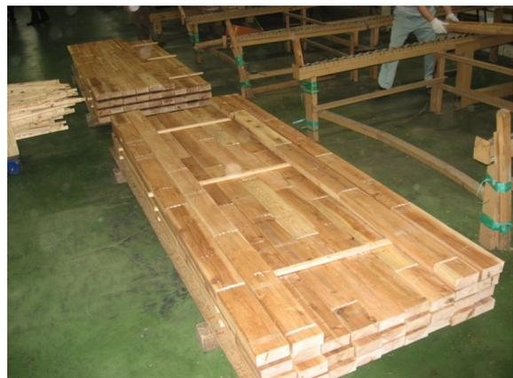
写真7 短尺材を縦継ぎした間柱
