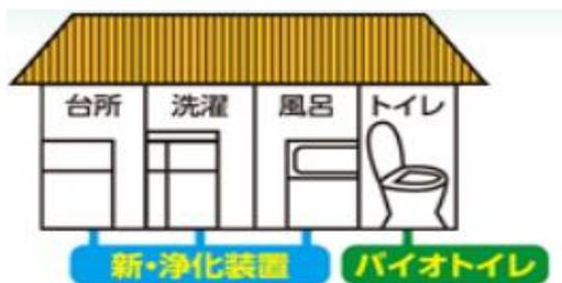
図 1 分けて処理する分散処理システム
