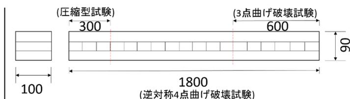
図 2 3 層 3 プライ CLT 試験体
