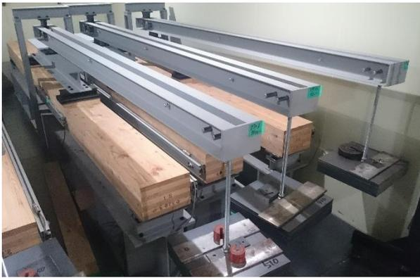
図 1 クリープ試験装置
