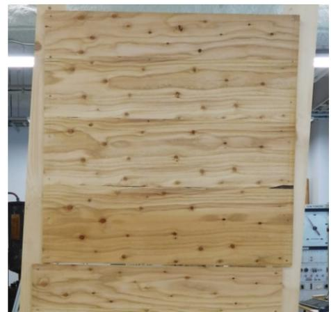
図-3 縦列釘打ち面材耐力壁の変形性状
