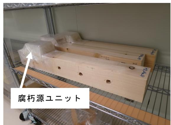
図 2 強制腐朽処理の様子
