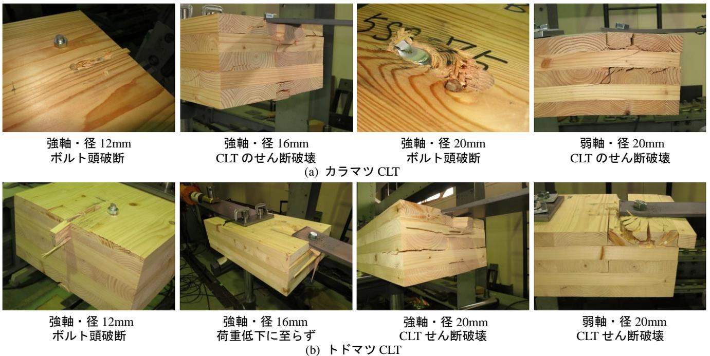
図4 代表的な破壊形態
