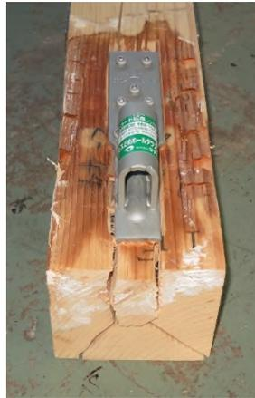
図 8 せん断による破壊
