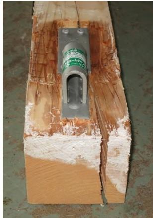
図 7 割裂による破壊
