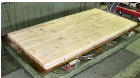
写真3 圧縮用原板のセッティング
