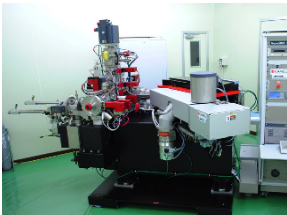
図1 東京大学 注) に設置されている NanoSIMS50L
