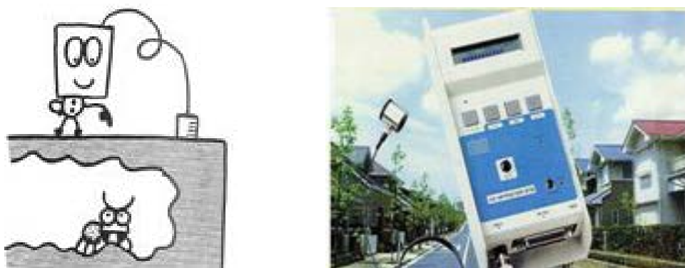
図 3 AE モニタリングの手法（左：藤井・築瀬画） とポータブル型シロアリ被害診断器（右）
