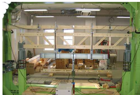
写真1 トラスの曲げ試験
