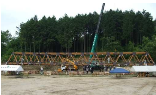
写真3 トラス橋の載荷破壊試験
