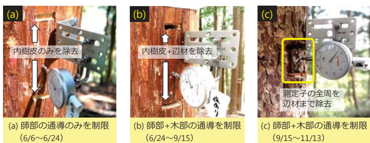
Fig. 9. 師部および木部の通導を制限して測定する方法
