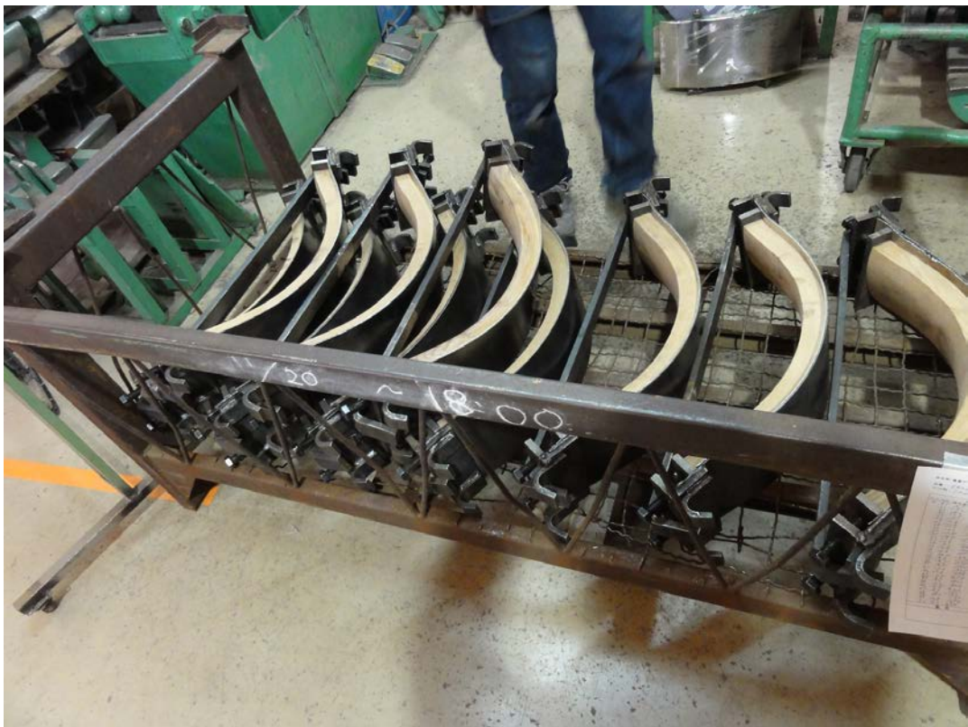
写真2 曲げ木加工した直後の木製家具部材(飛騨産業株式会社)
