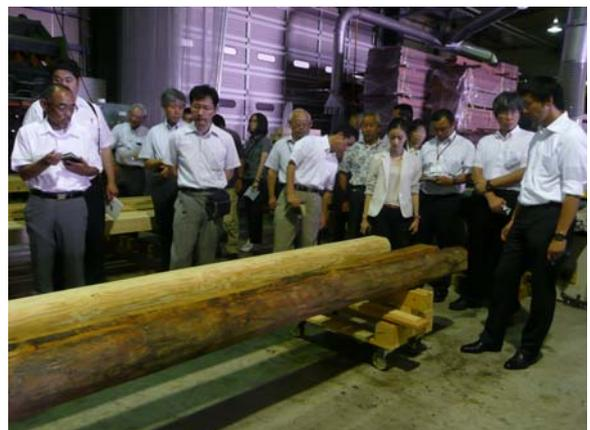
来ないとのことで、この原因は興味深いと感じられた。次に、大断面かつ長尺の接着重ね梁の製造工程を見せていただいた。ブランドとして「あずみ野赤松」、「信州ヒノキ」の重ね梁を4～6mのプレス機で製造しており、含水率や素材配置などの製造条件を管理し、完成品には全てヤング率が表示されており品質管理のレベルの高さが感じられた。
