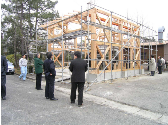
図 4 強化 LVL 接合の強度試験と実大実験モニターの設置
