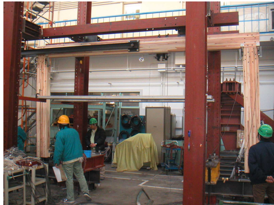
門型フレームの強度試験
