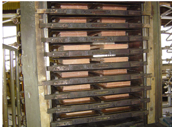
図2 強化 LVL の製造方法
