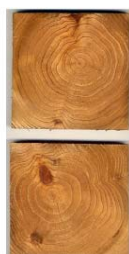
過熱水蒸気乾燥 130℃、72h
