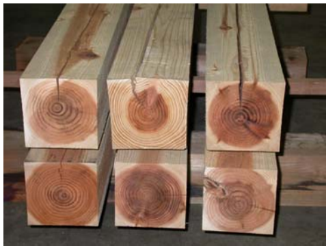
写真1. 心持ち柱材の典型的な表面割れ
