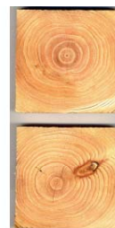
過熱水蒸気処理→RF/V乾燥 過熱:115℃、12h RF/V:60~70℃
