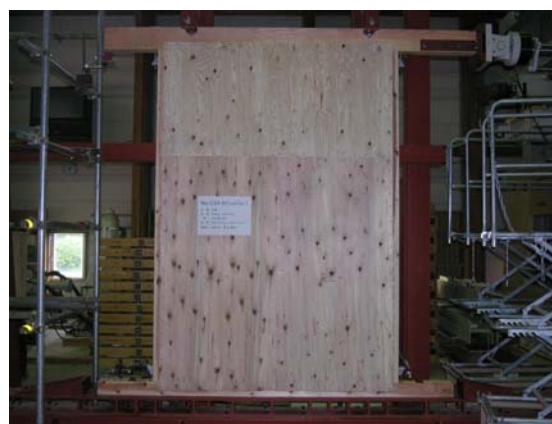
写真1 耐力壁の試験状況（直張り仕様）
