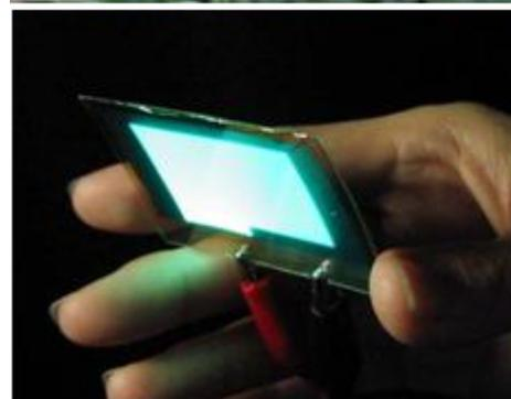
図7 セルロースナノファイバーで補強した透明材料(上)を透明基板に用いて有機EL発光に成功(下)。
