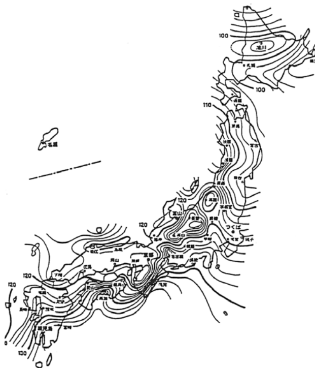
図1-2. 単板重量減少率による気象劣化マップ 23)
