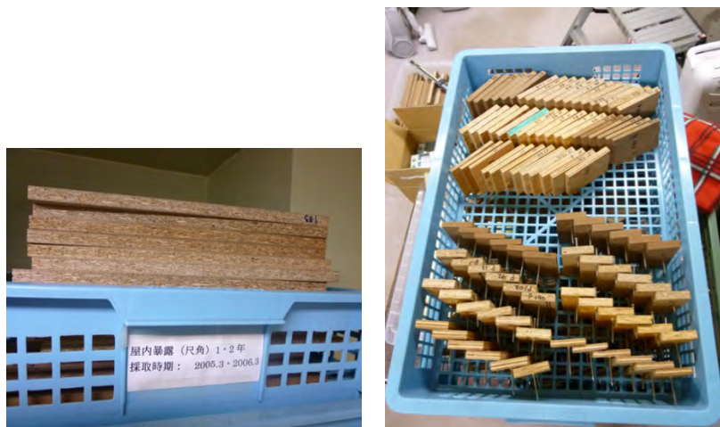
写真 1 試験体放置の様子（左：尺角パネル，右：釘接合試験片）
