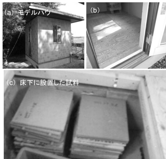
図1 モデルハウス床下の設置状況
