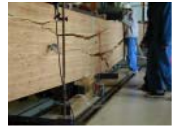
写真-4 集成材の強度試験
