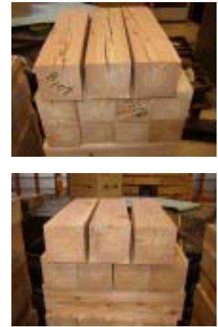
写真-6 高温セット処理と材面割れの比較(上:天然乾燥、下:高温セット処理材)
