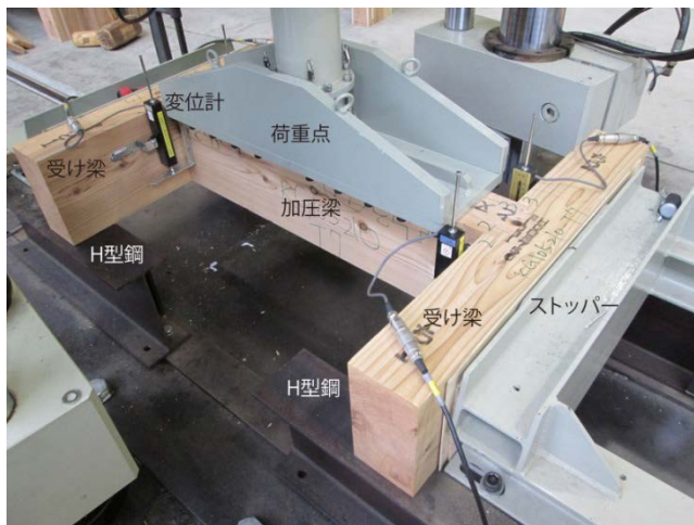
写真 1 横架材端接合部のせん断試験（梁-梁型）
