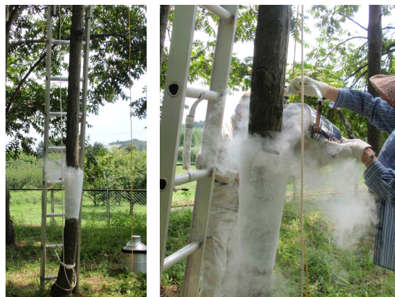
図-1 立木凍結法の実際 樹幹に取り付けた漏斗に液体窒素を注ぎ樹幹を凍結させ、凍結後に伐採する。
