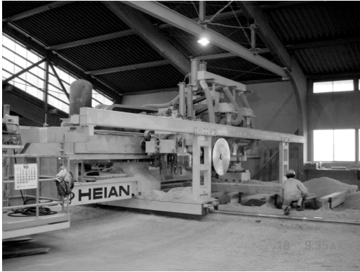
左：接合のための自動加工機、右：スリットおよびボルト穴加工された集成材（宮崎俊氏のアトリエ用の構造用集成材とのこと）
