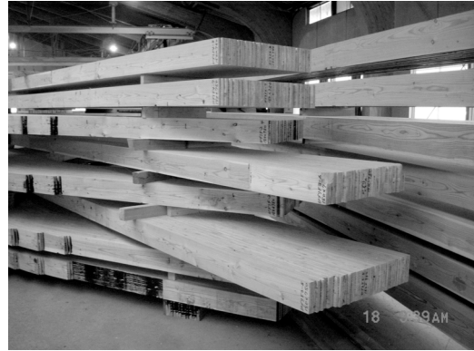
左：接合のための自動加工機、右：スリットおよびボルト穴加工された集成材（宮崎俊氏のアトリエ用の構造用集成材とのこと）
