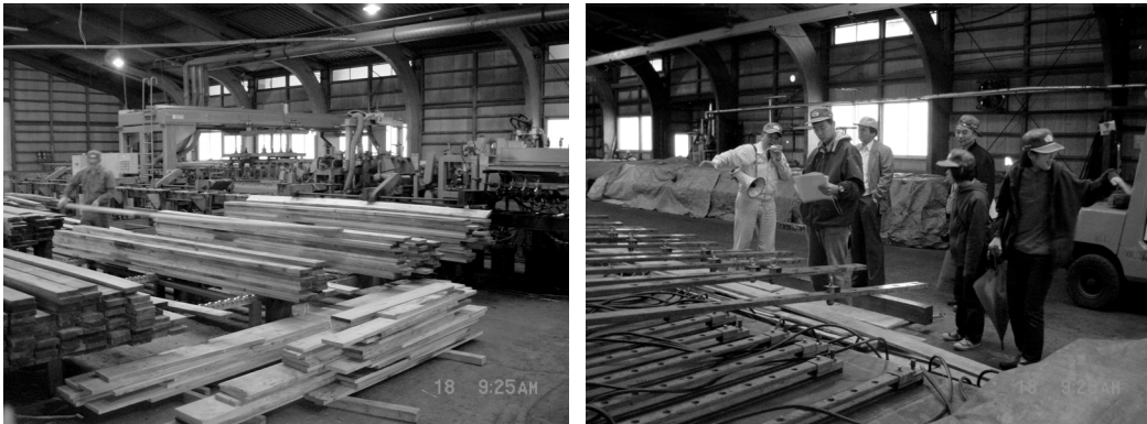
左：Auto-grading machine を通って、強度区分を側面の色分けで示されたカラマツラミナ材 右：集成加工のための圧縮装置の前で説明を聞く見学会参加者たち
