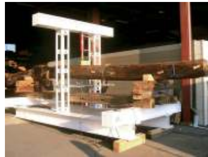
非破壊曲げ試験（2006年10月）
