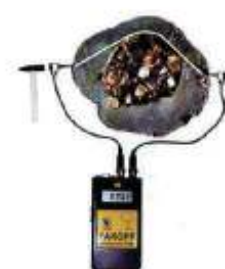
腐朽部を迂回する伝播イメージ 伝播時間が長い
